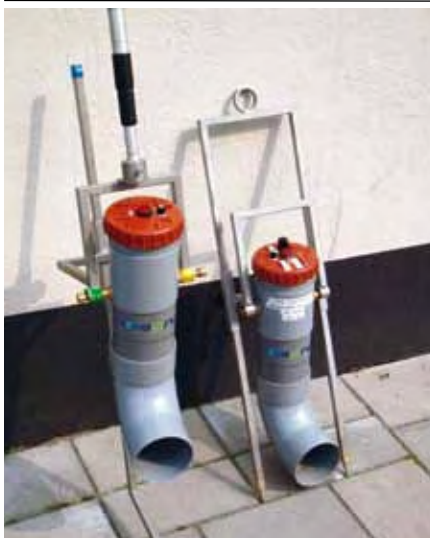
Figuur 5.3 Hulpstukken voor plaatsing geluidsbron in rioolput
