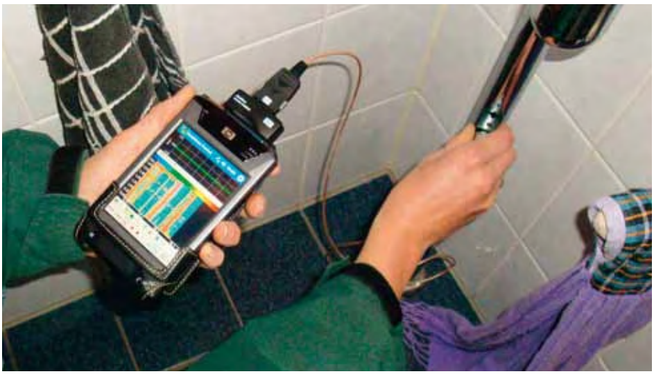
Figuur 5.2 Meting trillingen met sensor
