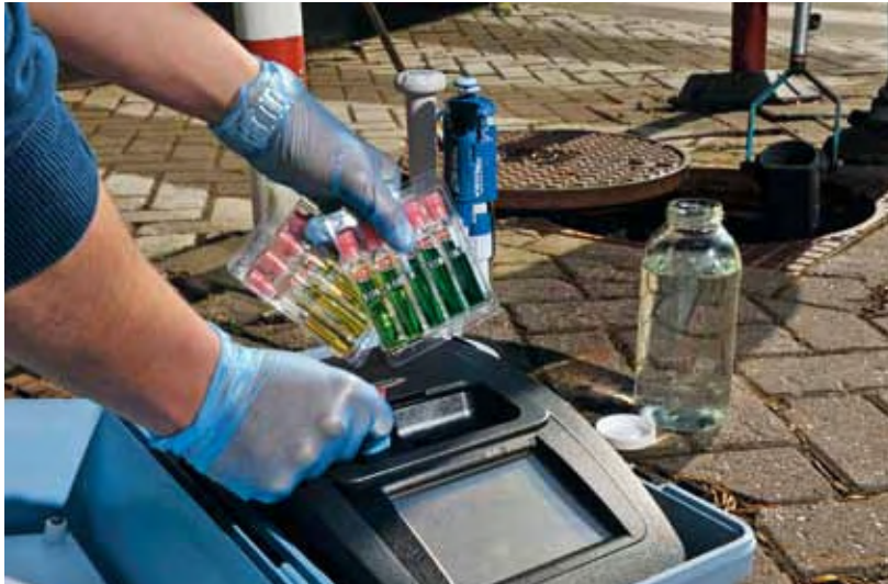
Figuur 2.3 Cuvet test ammonium
