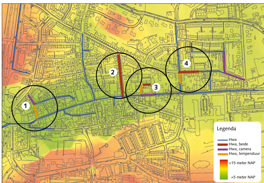
Figuur 3.9 Overzicht foutaansluitingen uit temperatuurmetingen en camera-inspecties
