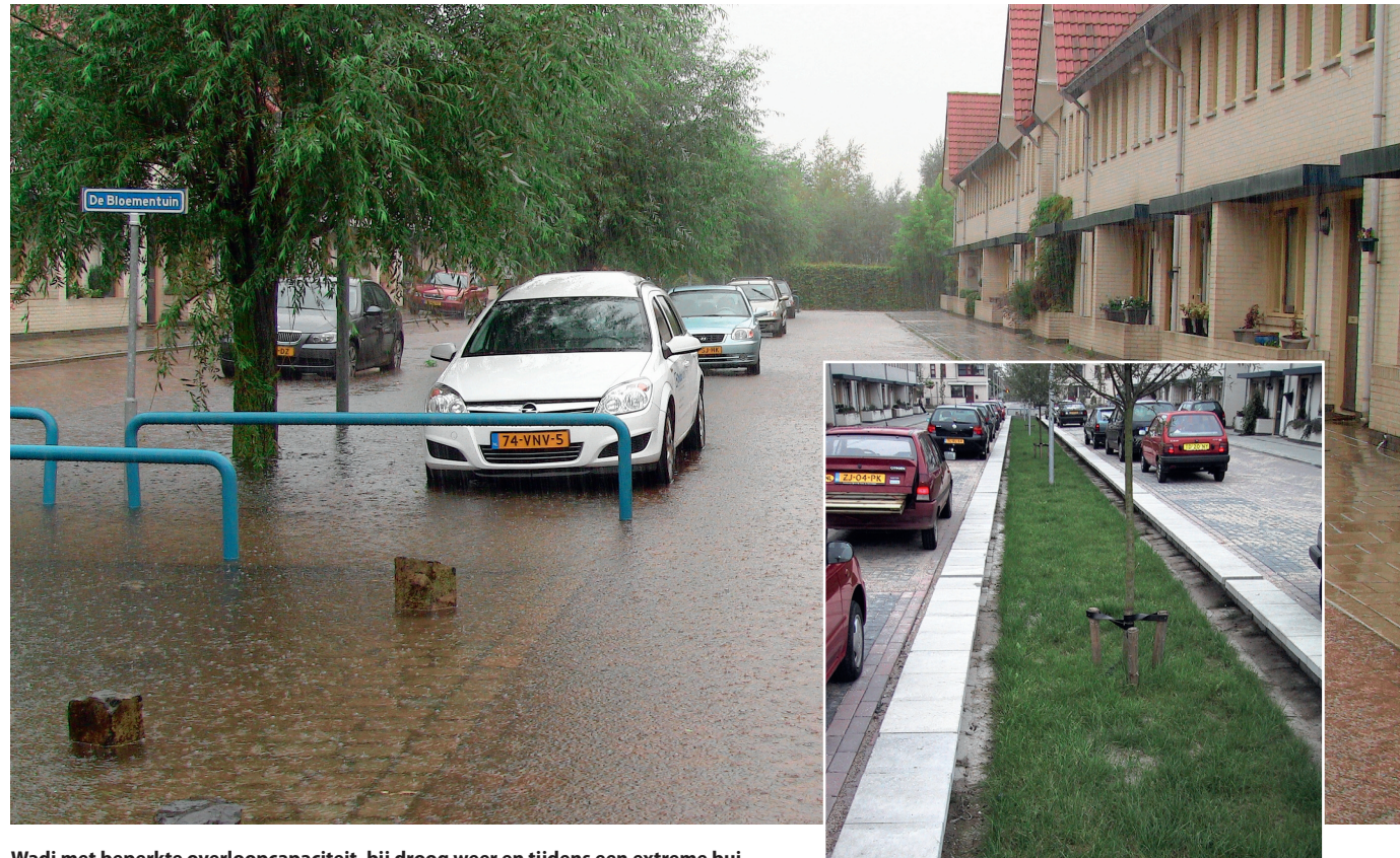
Wadi met beperkte overloopcapaciteit, bij droog weer en tijdens een extreme bui.
